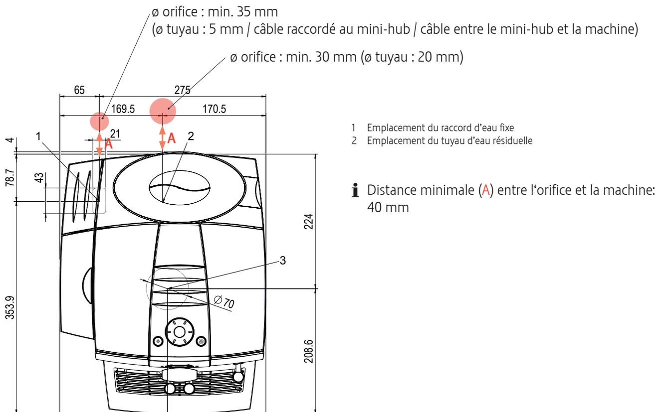
Emplacement de l'orifice commun pour le raccord d'eau fixe et le tuyau d'eau résiduelle dans le plan de travail
