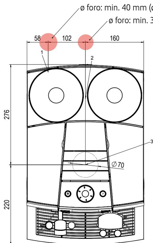
$\varnothing$  foro: min. 40 mm ( $\varnothing$  tubo flessibile: 35 mm)
