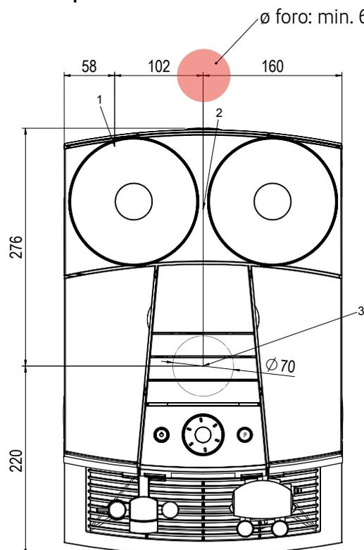
$\varnothing$  foro: min. 60 mm
