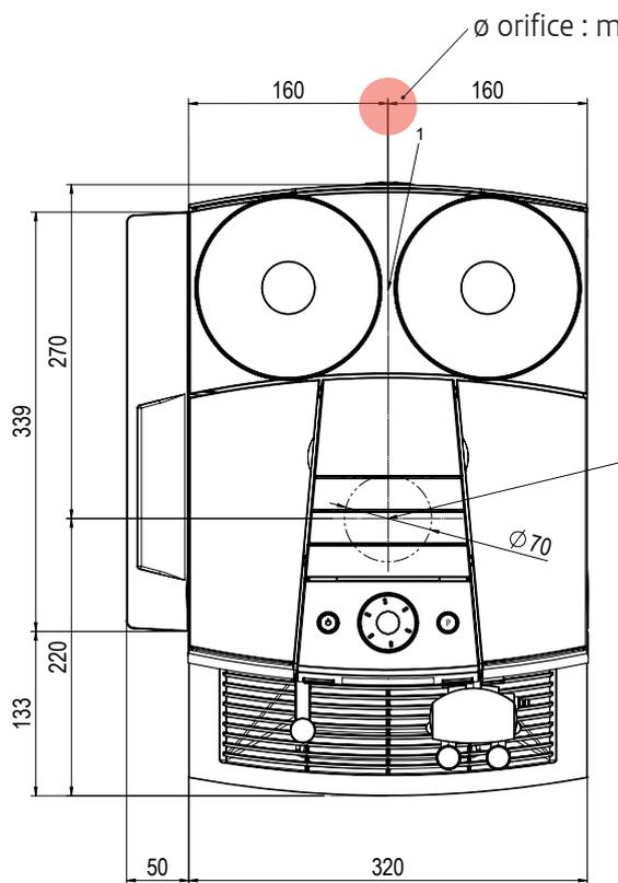
Ø orifice : min. 35 mm (Ø tuyau : 20 mm)
