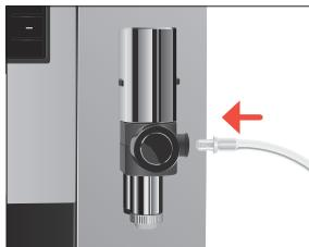
**i** O sistema de leite da sua W8 está equipado com a peça de ligação **HP3** e a saída de leite substituível **CX3**.
