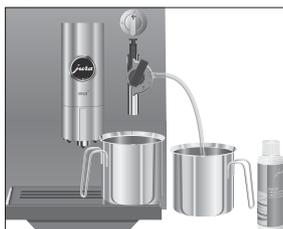
**i** Se si utilizza l'**ugello Professional Cappuccino**, ruotare la leva di selezione sulla posizione Schiuma di latte ☺ o Latte ☑.
